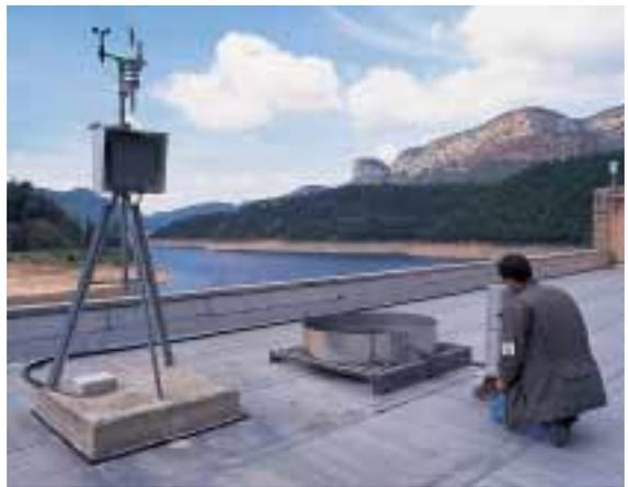
**Estación meteorológica.** El viento se mide con el aparato llamado anemómetro (a la izquierda), y su dirección se determina mediante una veleta instalada en dicho aparato. La cantidad de agua que cae se mide con el pluviómetro (a la derecha), en litros/metro cuadrado (l/m<sup>2</sup>).
