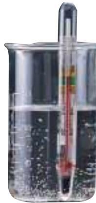
El **termómetro** mide la temperatura de un cuerpo. La temperatura se expresa en grados centígrados (°C).
