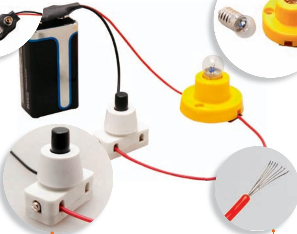
Los interruptores tienen partes internas que son conductoras de la corriente eléctrica y permiten su paso cuando cierran el circuito.
