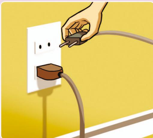
Sostén los enchufes por la parte recubierta con material aislante al conectar y desconectar de la red eléctrica. Para desconectar los aparatos eléctricos, tira del enchufe y no del cable.
