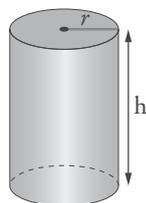
La superficie lateral de un cilindro es un rectángulo cuya base es igual al perímetro del círculo,  $2\pi r$ , y cuya altura,  $h$ , es la del cilindro.
