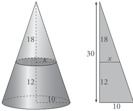
1. Un cono de 10 cm de radio en la base y 30 cm de altura se corta por un plano paralelo a la base a 12 cm de ella. Calcular el volumen del tronco de cono obtenido.
