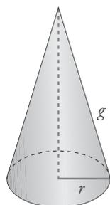
El desarrollo lateral de un cono es un sector circular de un círculo de radio  $g$ , y abarca un arco cuya longitud coincide con la de la circunferencia base del cono ( $2\pi r$ ).
