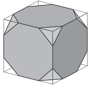
Truncando los vértices de un cubo a distancias adecuadas de los vértices se obtiene un poliedro semirregular (llamado **cubo truncado**), en cada uno de cuyos vértices concurren dos octógonos y un triángulo.
