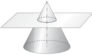
Si cortamos un cono por un plano perpendicular a su eje, la línea de corte es una **circunferencia**.
