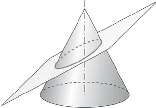
Si el plano que corta al cono tiene una cierta inclinación respecto a su eje, la línea de corte es una **elipse**.
