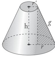
En un tronco de cono, la altura,  $h$ , la diferencia de los radios,  $r - r'$ , y la generatriz,  $g$ , forman un triángulo rectángulo. Por tanto:
