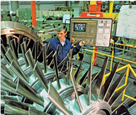
Turbina de vapor. Esta turbina gira cuando la impulsa un chorro de vapor a presión.
