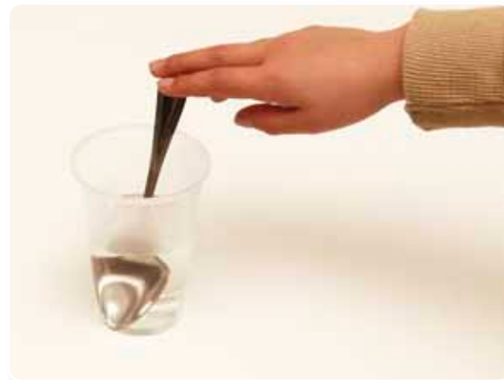
▲ Transferencia de calor por conducción.
